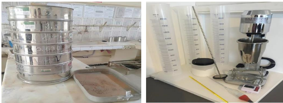
Figure 9. Appareillage d'analyse granulométrique (tamisage et sédimentométrie)
