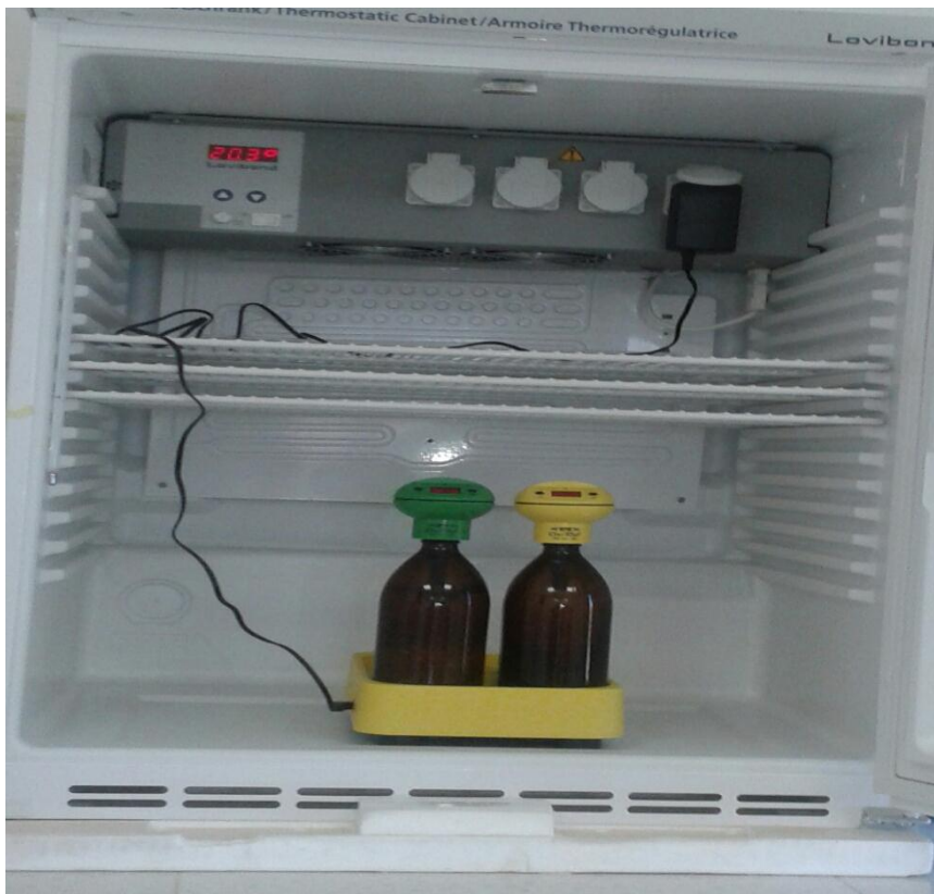
Figure.12 : Le DBO mètre utilisé dans la station d'épuration des eaux usées de M'sila.
