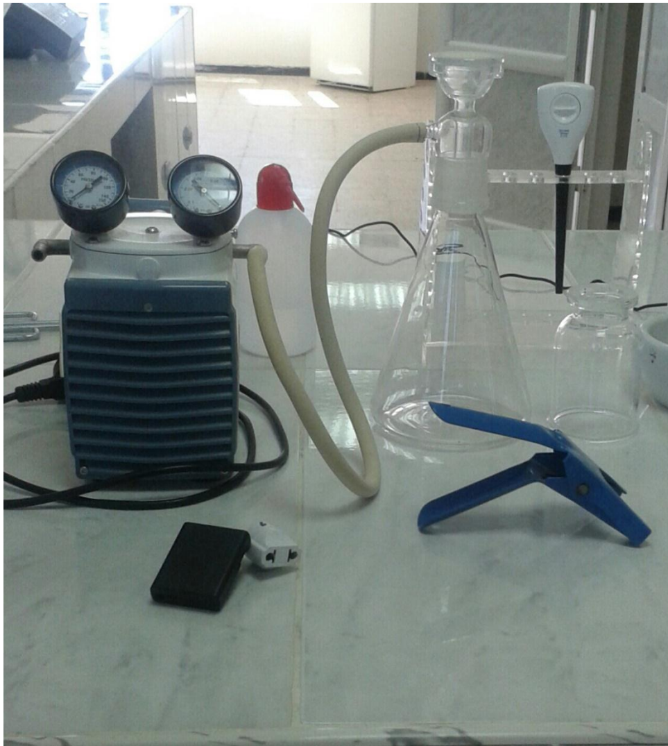
Figure.11: Les équipements utilisés pour la filtration (Pompe à vide)
