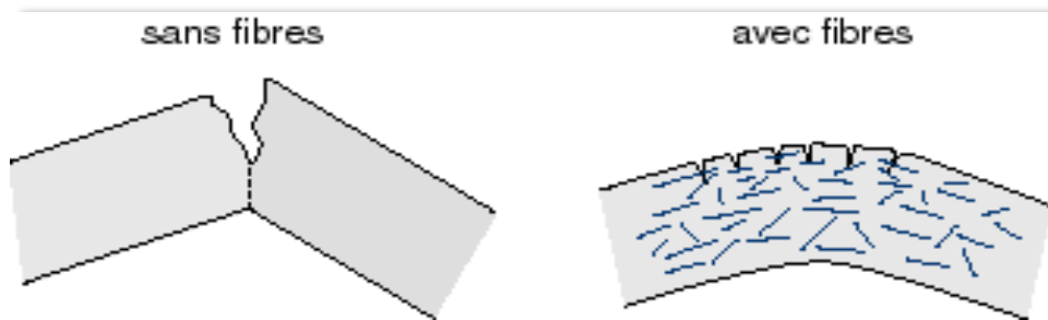
Figure.I.17: Fissuration dans le béton sans et avec fibres. [18]
