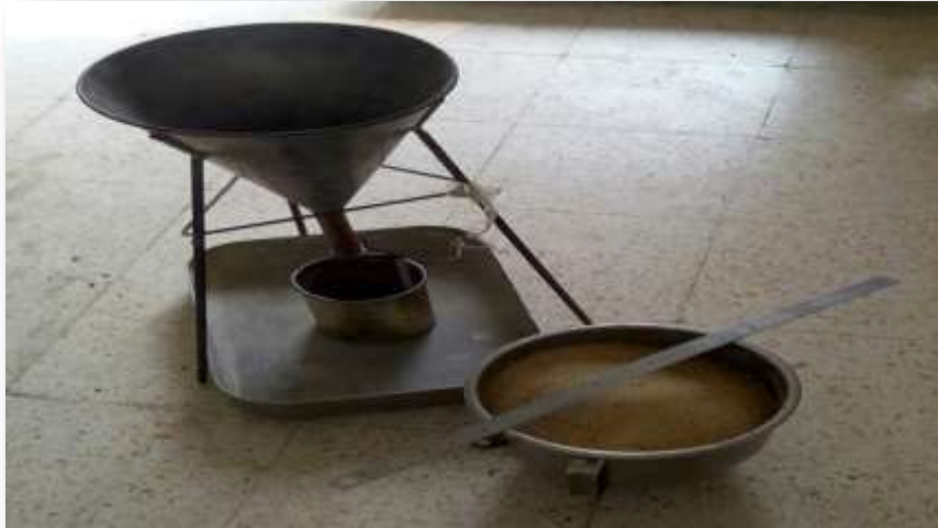
Figure II-2: Détermination de la masse volumique apparente d'un matériau.
