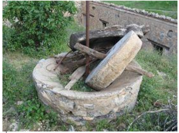
الصورة رقم 13 : رحي الزيتون تستخدم لسحق الزيتون لاستخراج الزيت
