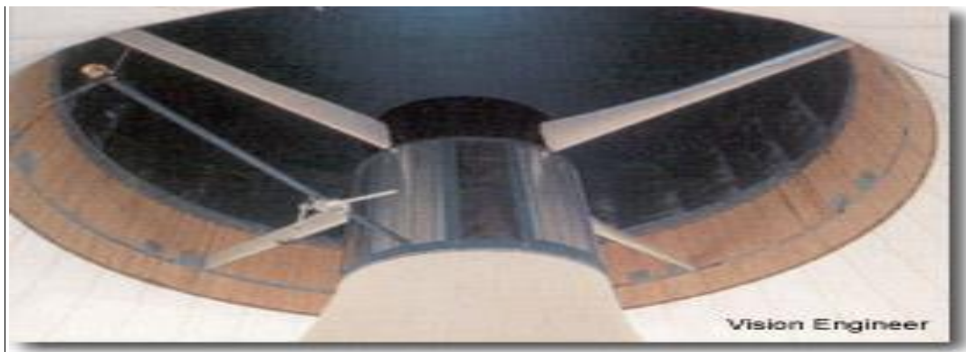
Figure(I .3 a) : Turbine pour centrale solaire à cheminée [web1]
