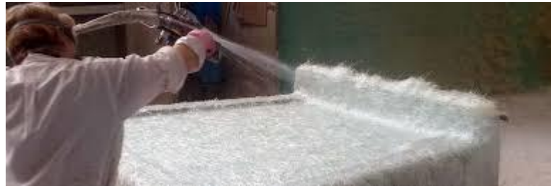
FIG I.10 :Moulage par projection simultanée
