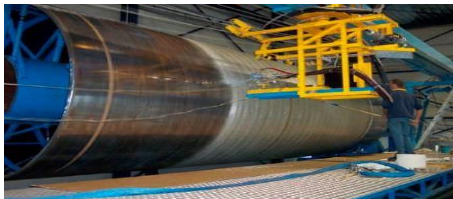
FIG I.15 :Enroulement filamentaire (ou bobinage)
