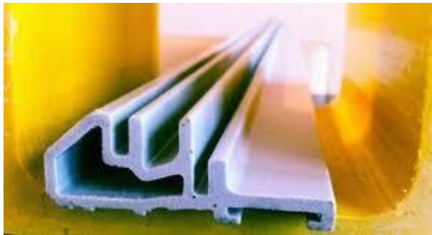
FIG I.14: La pultrusion des matériaux composites
