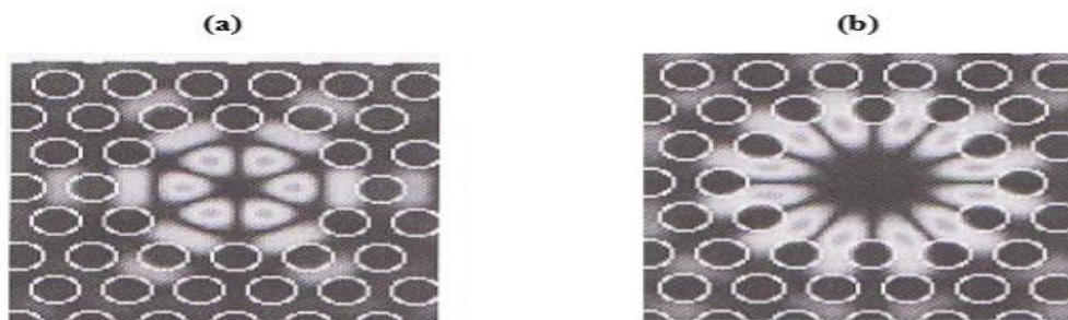
Figure II.1 : Exemples de cartes d'amplitude du champ magnétique de deux modes TE d'une cavité « H2 », issues d'une simulation 2D : (a) Mode de type radial ; (b) Mode de type « galerie » [33].
