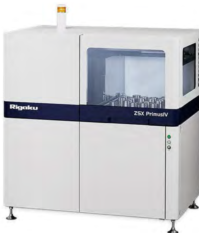
Fig. II.7: XRF ZSX Primus IV.
