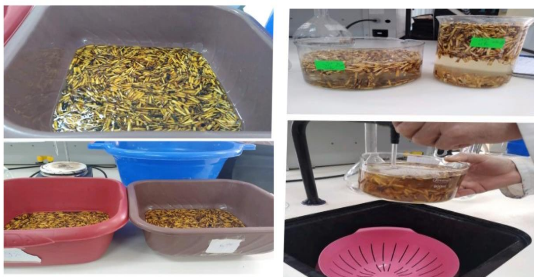
Figure .31 :Tremper les fibres de Cynodon Dactylone dans une solution d'hydroxyde de sodium
