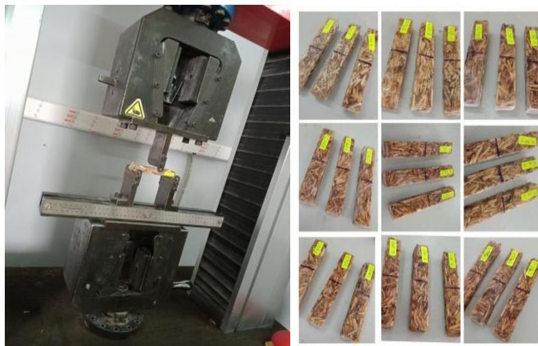
Figure .36 :Test de flexion avec des l'éprouvette
