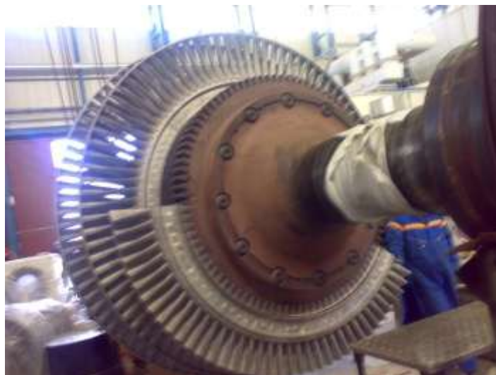
Fig. III.9: Procédure de répartition les aubes d'un rotor d'une turbine MEI Sonalgaz M'sila [45].
