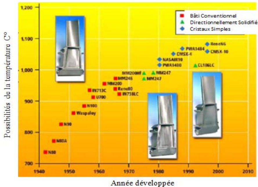
Figure II.8 : Développement de matériaux d'aube depuis 1940 jusqu'à ce jour [22].
