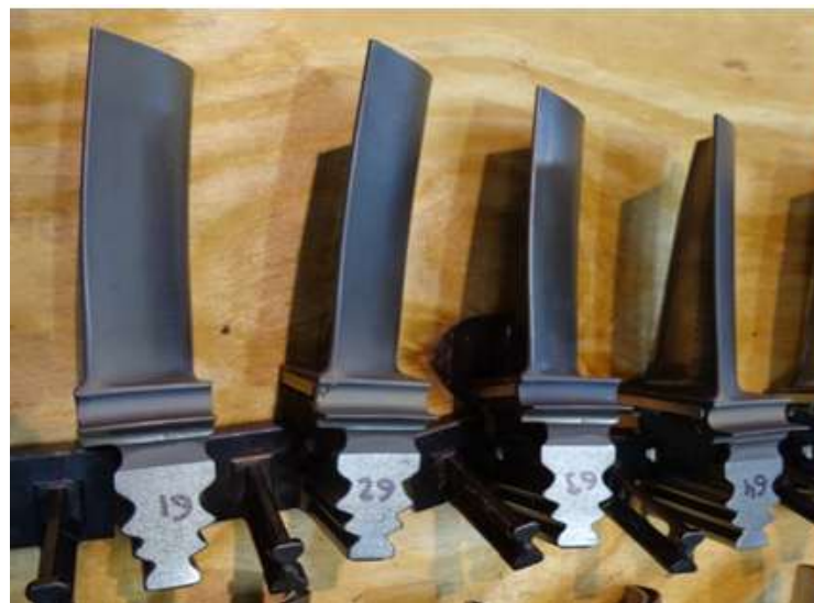
Figure IV.38: Numérotation des aubes par ordre de résultat.
