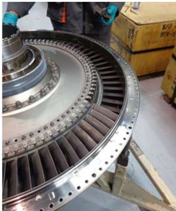
Figure IV.40: Vue d'un disque rotor en cours de montage des aubes par ordre des résultats de la répartition statique.
