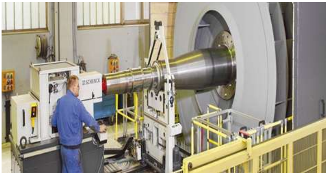
Figure III.8. Balance d'équilibrage statique utilisée pour des Rotors Turbomachine [35].
