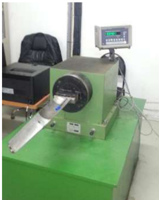
Figure IV.2: Mesure des moments statique avec une balance de type WM (MEI SONALGEZ M'sila).
