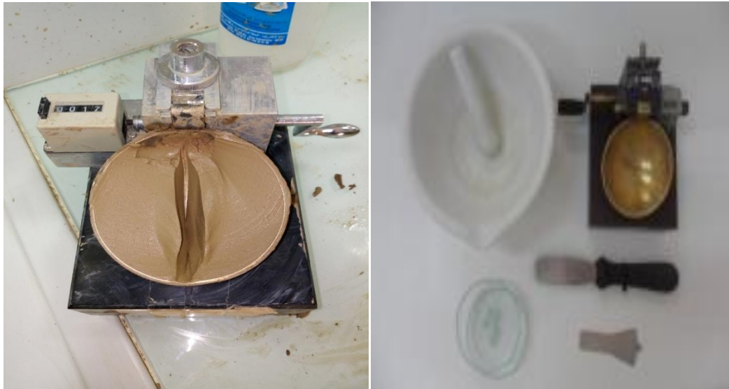
Figure 4.4 : Appareillage de limites d'Atterberg.
