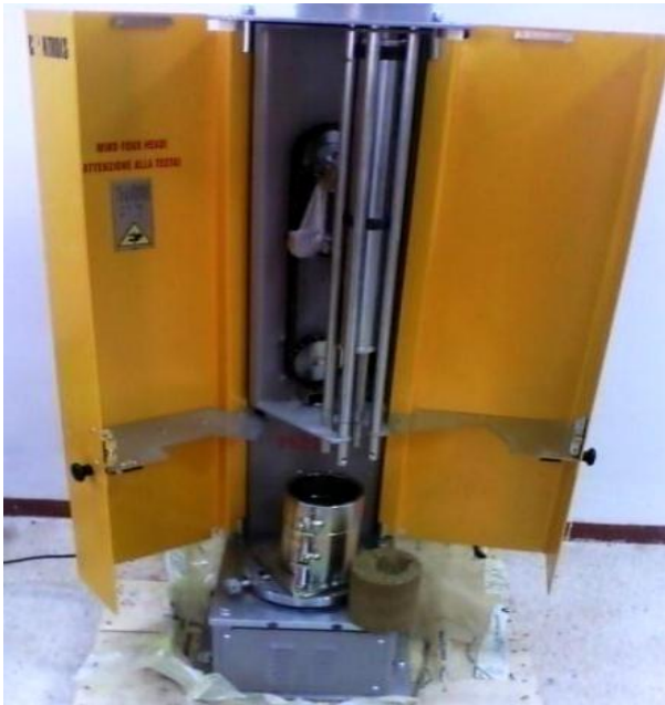
Figure 4.8 : Appareil essai Proctor (compacteur automatique).
