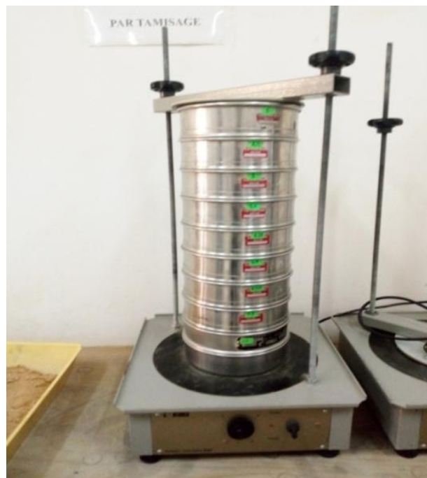
Figure 4.2 : Appareillage d'analyse granulométrique (tamisage).
