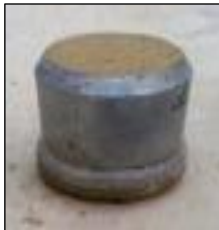
Figure 4.1 : Détermination du poids volumique humide.
