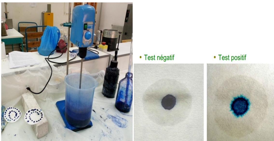
Figure 4.5 : appareillage de l'essai au bleu de méthylène.
