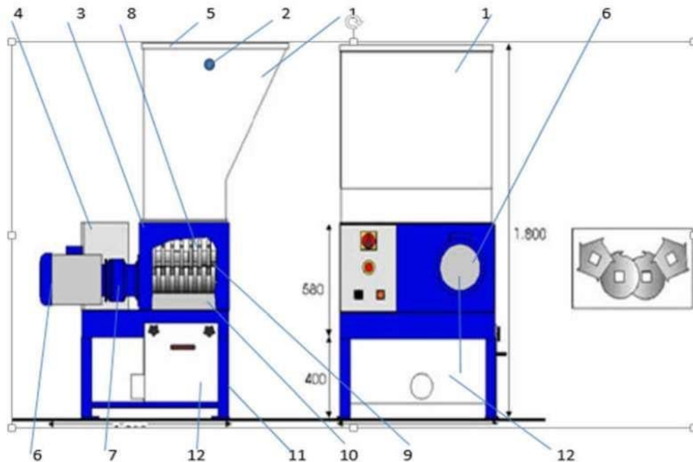
Fig.5.2: Différents éléments d'un broyeur plastique.
