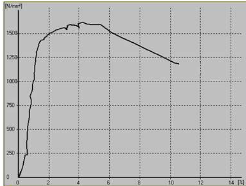
Fig IV. 1 : Courbe de traction (contrainte- déformation à la température de revenu 350°C).
