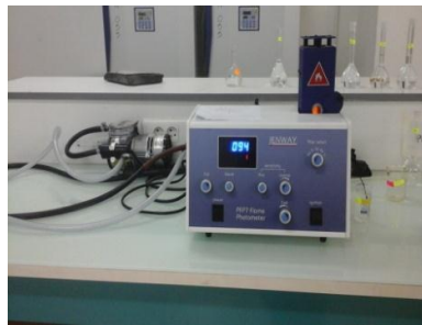
Figure N°18: Dosage de \text{Na}^+ et \text{K}^+ à l'aide de photomètre de flamme
