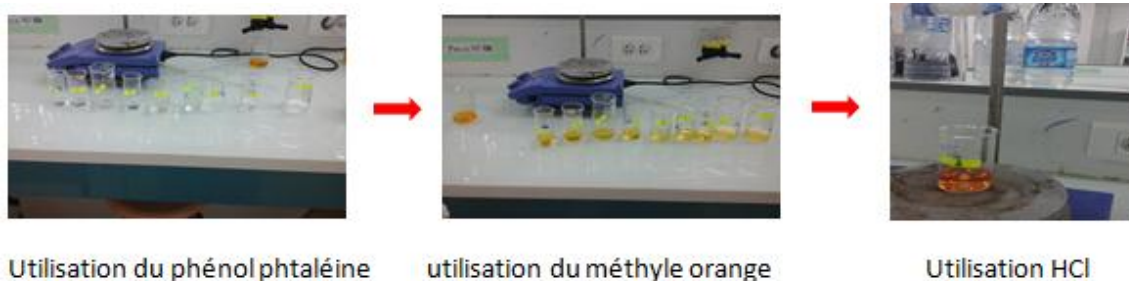
Figure N°14: Etapes principales du dosage de TA et TAC
