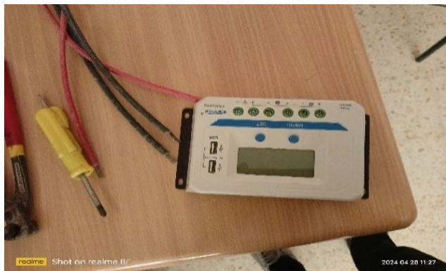
Figure IV-7: Contrôleur MPPT de 12-24V
