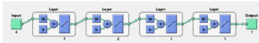
Figure (III.22) : Architecture de réseau de 3 couches cachées, 7 neurones dans la 1 ère couche cachée et 2 neurones dans la 2 ème couche cachée et 1 neurone dans la 3 ème couche cachée.
