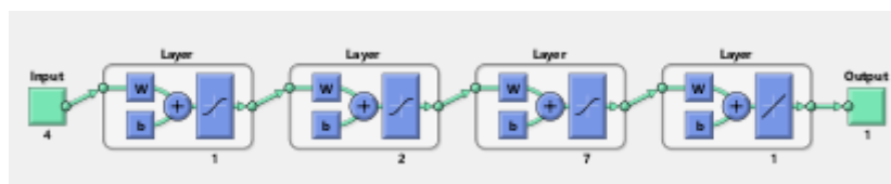
Figure (III.25) : Architecture de réseau de 3 couches cachées, 1 neurone dans la 1 ère couche cachée et 2 neurones dans la 2 ème couche cachée et 7 neurones dans la 3 ème couche cachée.
