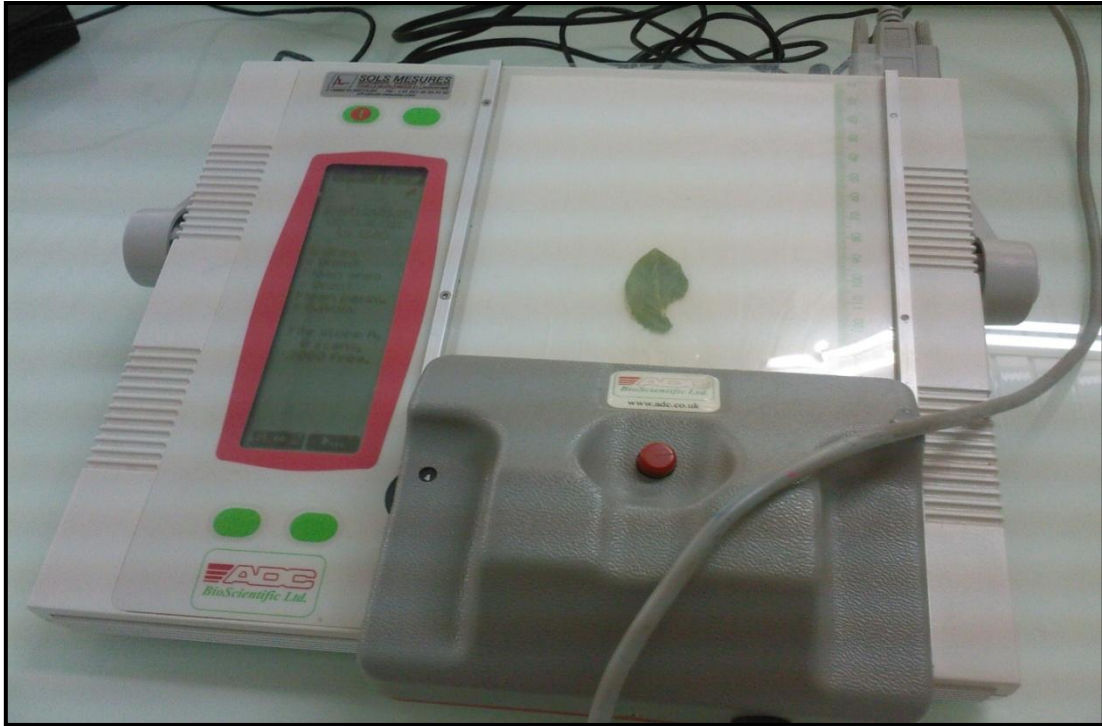
Figure 04: Mesure de la surface foliaire à l'aide d'un planimètre
