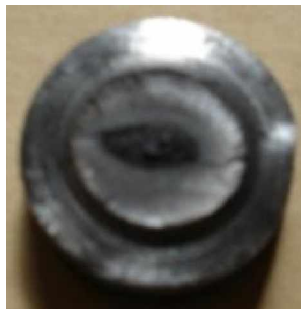
Figure V.11. Faciès de rupture d'une éprouvette d'essai de fatigue en flexion rotative sous une charge de 300 MPa après 12000 cycles
