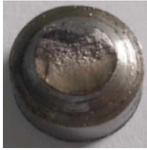
Figure V.10. Faciès de rupture d'une éprouvette d'essai de fatigue en flexion rotative sous une charge de 280 MPa après 10^6 cycles
