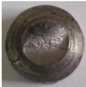
Figure V.12. Faciès de rupture d'une éprouvette d'essai de fatigue en flexion rotative sous une charge de 320 MPa après 18000 cycles
