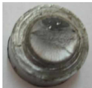
Figure V.9. Faciès de rupture d'une éprouvette d'essai de fatigue en flexion rotative sous une charge de 260 MPa après 3 \cdot 10^6 cycles
