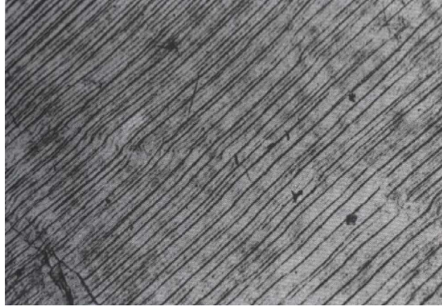
Figure 1.13. Stries observées sur la surface de rupture d'une éprouvette de nickel technique rompue par fatigue après 212000 cycles (X 10000) [1]
