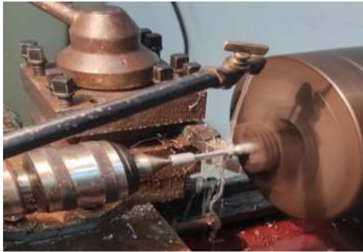
Figure 3.6: Tournage de l'éprouvette.
