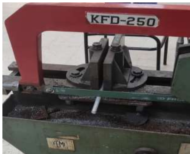
Figure 3.5 : découpage de l'éprouvette (ébauche).
