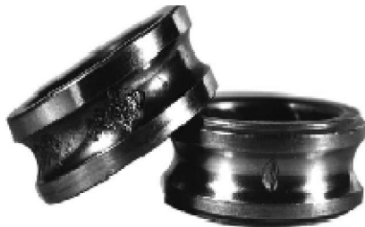
Figure I.15 : Défaut sur la bague intérieure
