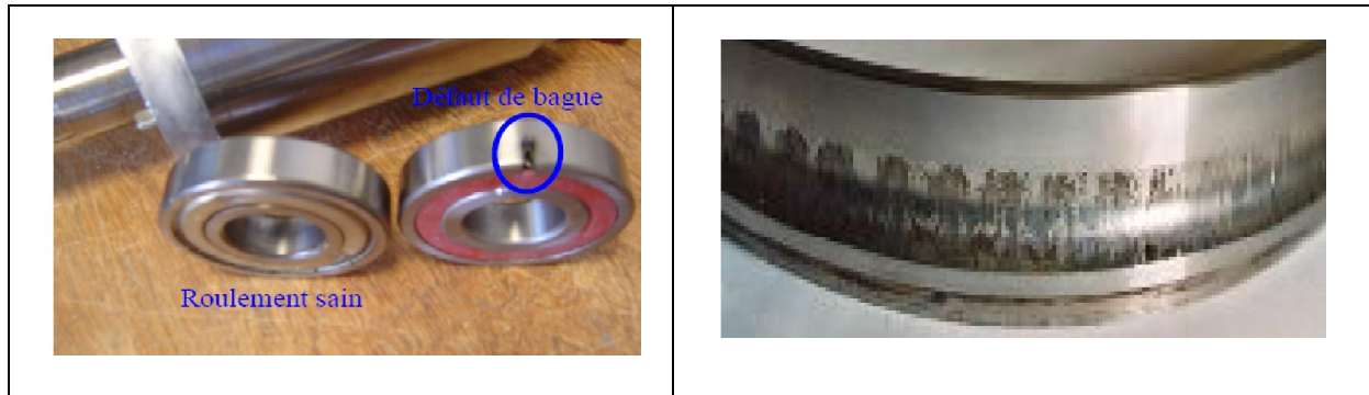
Figure I.14 : Défaut sur la bague extérieure
