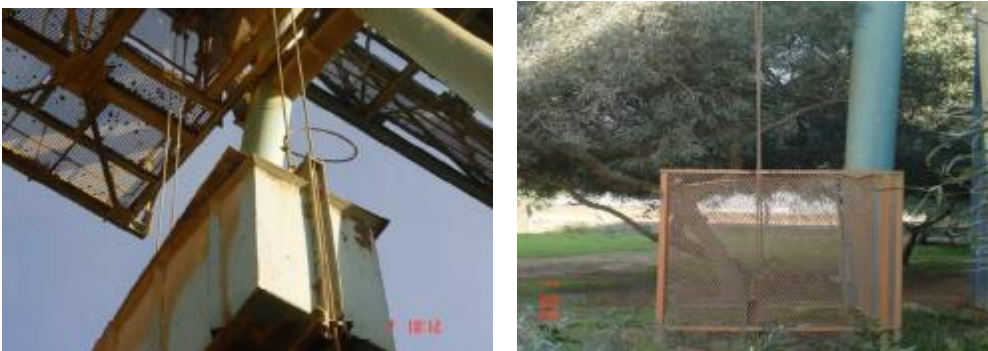
Fig. IV.5 Protection du contre poids
