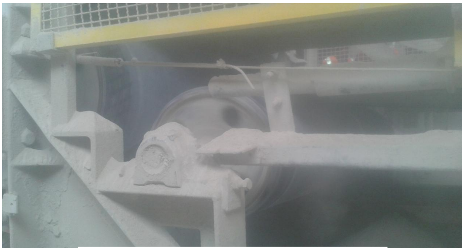
Fig.II.6 Tambours du convoyeur [26]
