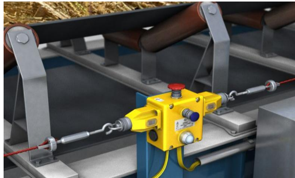
Fig.IV.7 Arrêt d'urgence à câble [57]
