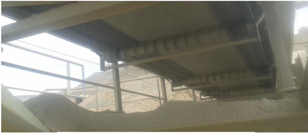
Fig. II.4 Rouleaux porteurs inférieurs [26]
