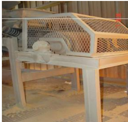
Fig.IV.10 Carters de protection du tambour de queue [57]
