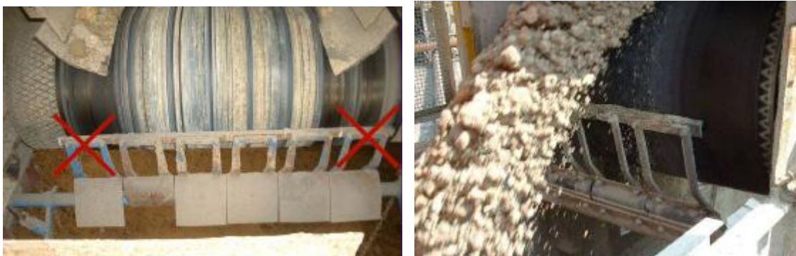
Fig.IV.2 Disposition de Lame racleuse
