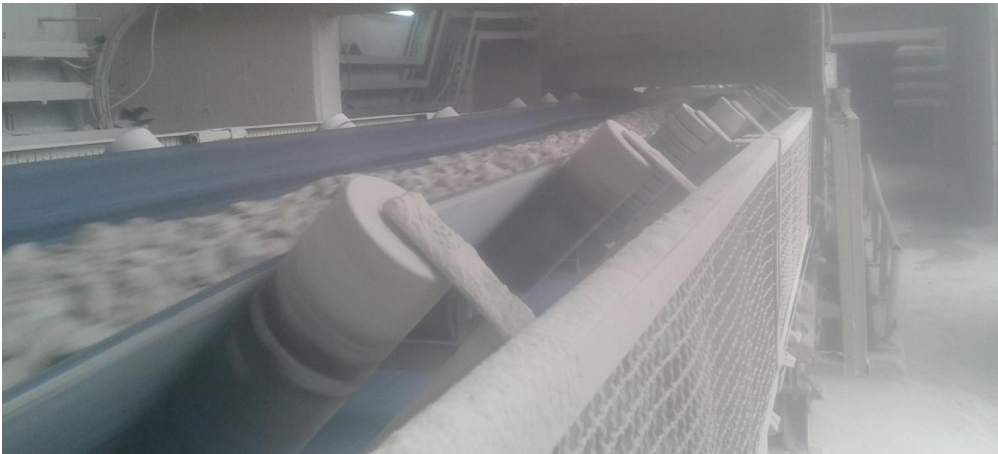
Fig.II.3 Fixation des rouleaux sur la station-support [26]
