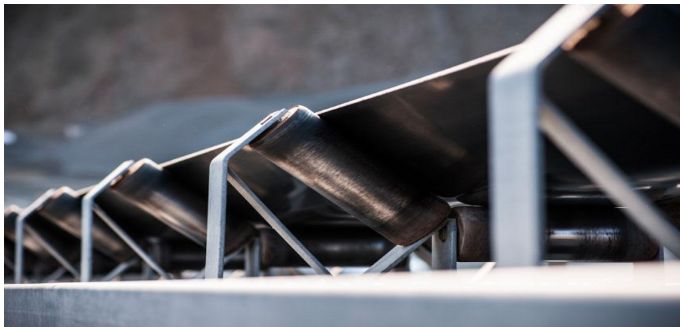
Fig. I.8 Fixation des rouleaux sur la station-support [21]
