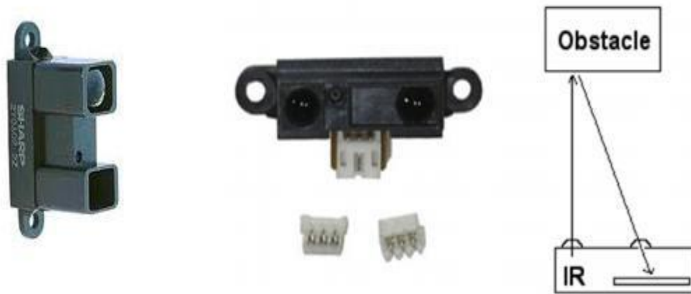
Figure 1.9. Principe du télémètre infrarouge à triangulation et exemple de télémètre réel
