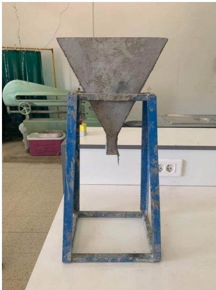
Figure I-6– Déroulement de l'essai d'entonnoir en mini v (v-funnel).
