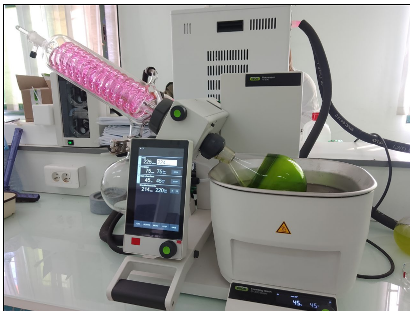
Figure 13: Montage de Rota-vapeur utilisé pour obtenir l'extract brut (Cliché : ASSELI et TITRAOUI 2025)
