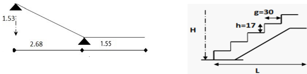
Figure II-6 : Coffrage Les escaliers.
