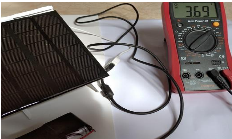
Figure IV. 10 : test de recharge de la batterie
