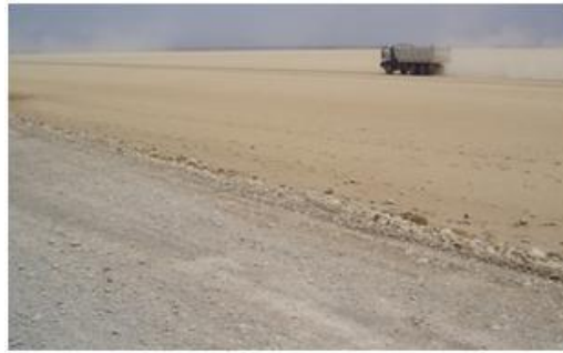
Figure 4.3: Illustration de la forte portance du sol de sebkha à l'état sec
