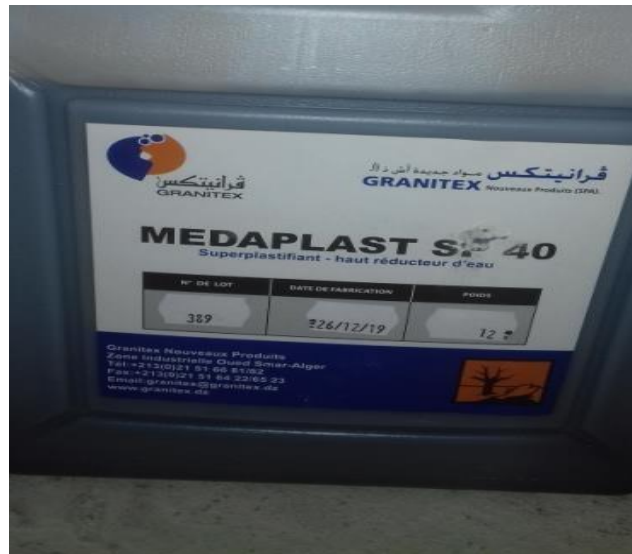
Figure3.11 : MEDAPLAST SP 40, est un super plastifiant à base de de polymères- (Laboratoire des Géo matériaux – université de Msila) .
