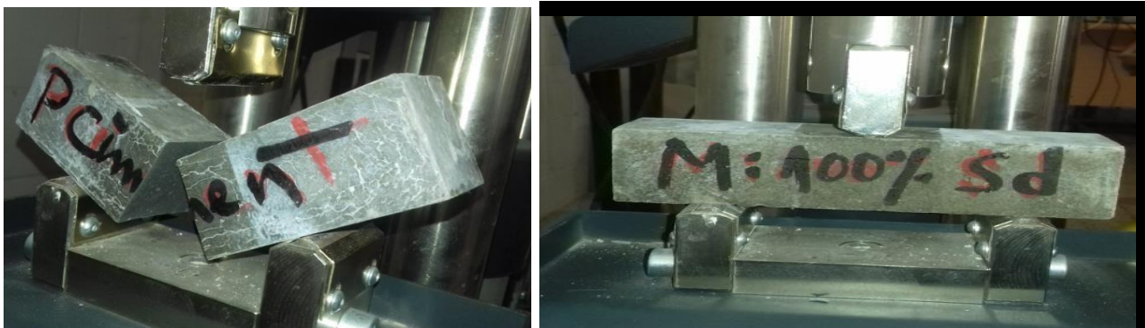
Figure 3.19: Dispositif pour l'essai de la résistance traction par flexion . (Laboratoire du développement et recherche des Géo matériaux – université de Msila)
