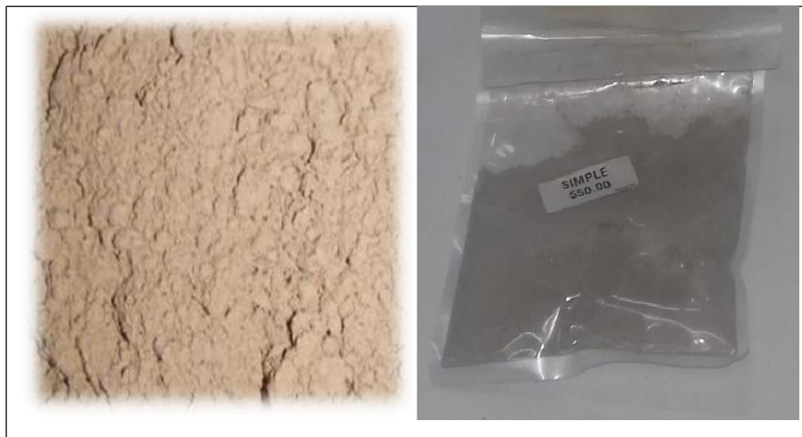
Figure 3.10: Echantillon de laitier-Granule. (Laboratoire des Géo matériaux – université de Msila) université de Msila
