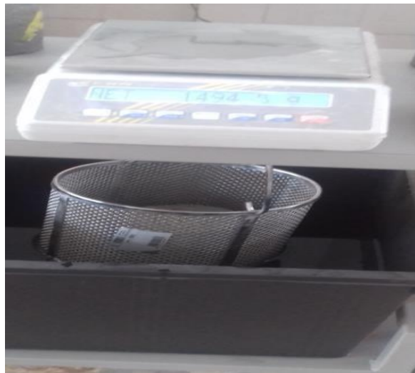
Figure 3.24: Dispositif de la Pesée hydrostatique ,Saturation en eau sous- eau pendant mesuré la masse dans récipient l'eau . (Laboratoire des Géo matériaux – université de Msila).
