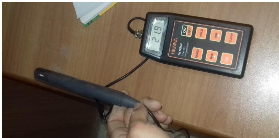
Figure 3.16 : appareille pour mesuré la (température et humidité ). (Laboratoire des Géo matériaux – université de Msila) université de Msila
