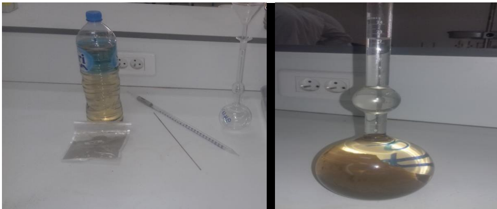
Figure 3.9 : essais de surface spécifique du laitier granulé (Laboratoire des Géo matériaux – université de Msila).
