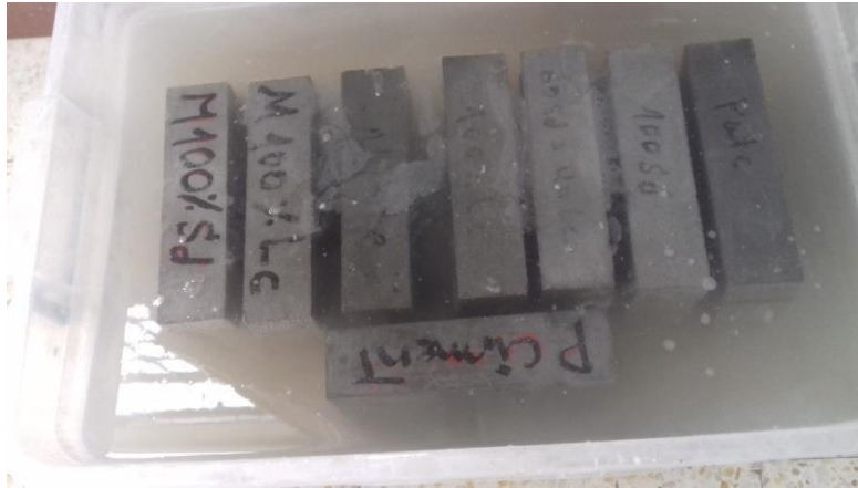
Figure 3.22 : agressions chimiques des éprouvettes immergées dans ces solutions acides. (Laboratoire des Géo matériaux – université de Msila) .
