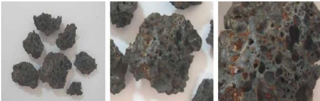
Figure 1.6: Laitiers d'aciérie électrique ayant une structure poreuse et rugueuse [14].
