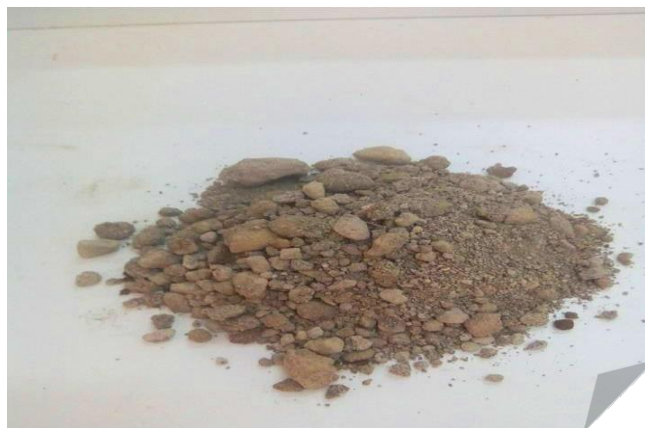
Figure 1.1 : Laitier cristallin [laboratoire de génie civil université de Msila].
