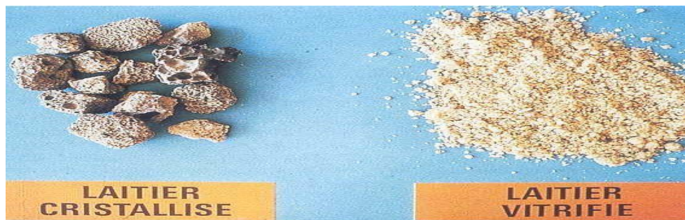
Figure 1.9– Laitier cristallisé et laitier vitrifié granulé de haut fourneau [32].
