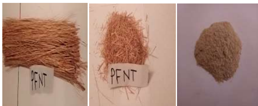
الشكل (27): ورق ألياف النخيل المحضرة.
