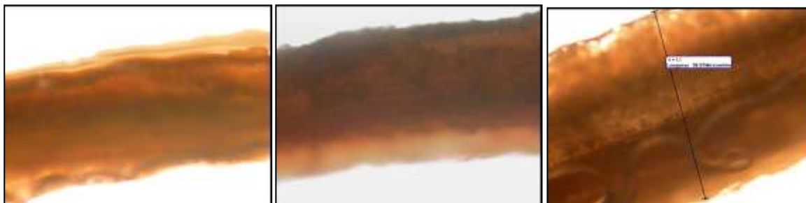
الشكل (39): صورة بالمجهر الضوئي لألياف النخيل غير المعالجة (P0000).
