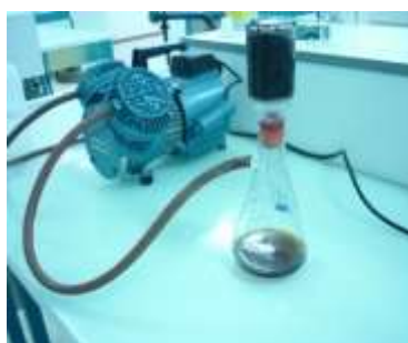
الشكل (25): ترشيح عينة الليجنين وتجفيفها.
