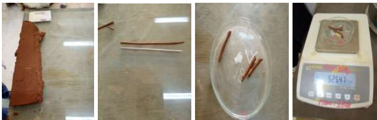
الشكل(30): خطوات قياس حد اللدونة.
