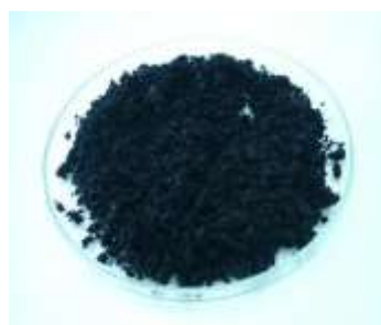
الشكل (25): ترشيح عينة الليجنين وتجفيفها.
