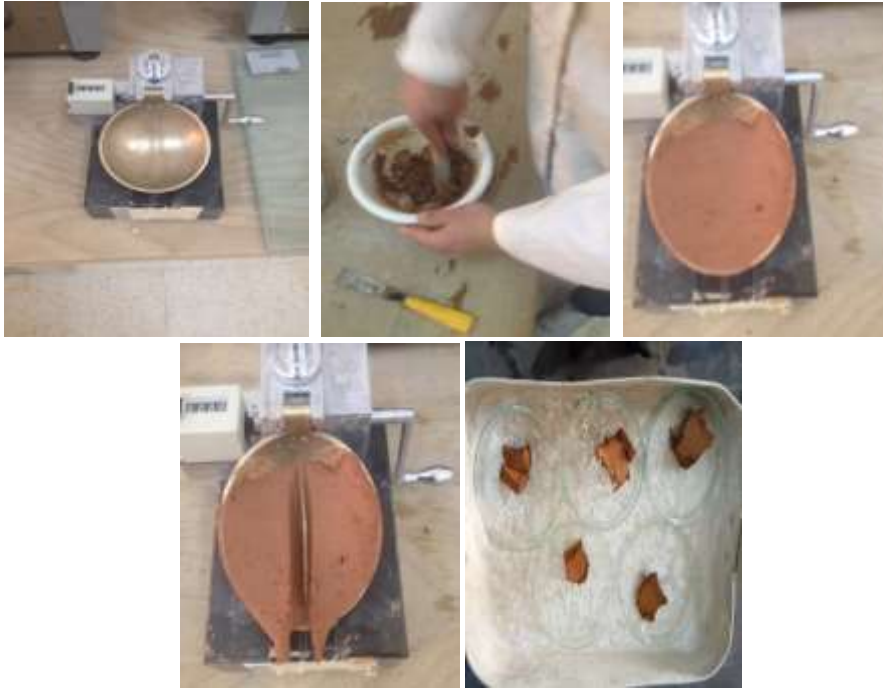
الشكل (29): خطوات قياس حد السيولة.
