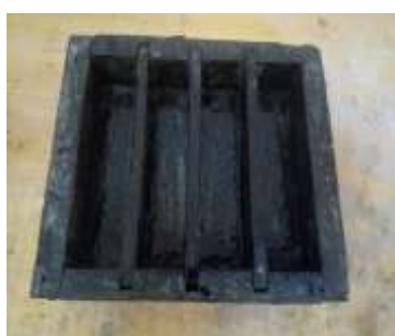
الشكل(31): القالب المستعمل في اختبار الثني والضغط.
