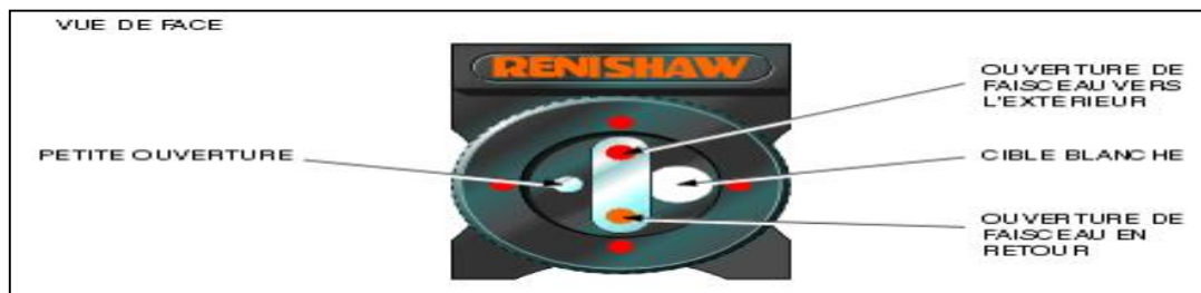
Figure III-17 Orientation pour mesurer la déviation de rectitude horizontale.
