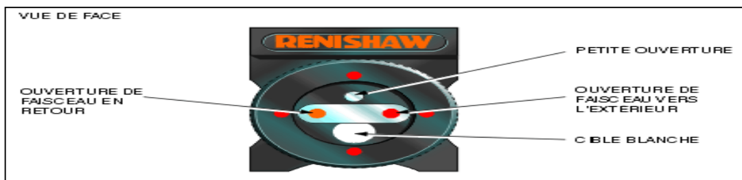
Figure III-18 Orientation pour mesurer la déviation de rectitude verticale.
