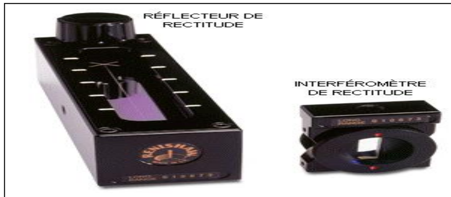
Figure III-16 Optique de mesure de rectitude.
