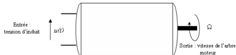
Figure (I.7) : Moteur à courant continu asservi en vitesse.
