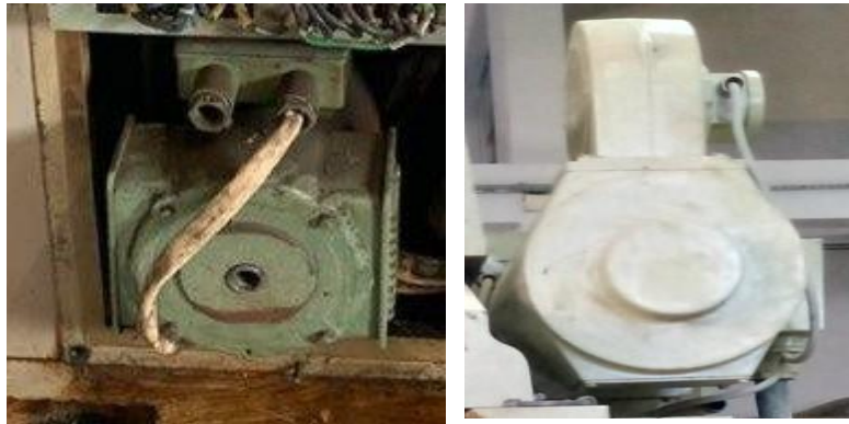
Figure IV.10. Moteurs de la table à gauche et le moteur de la broche à droite.
