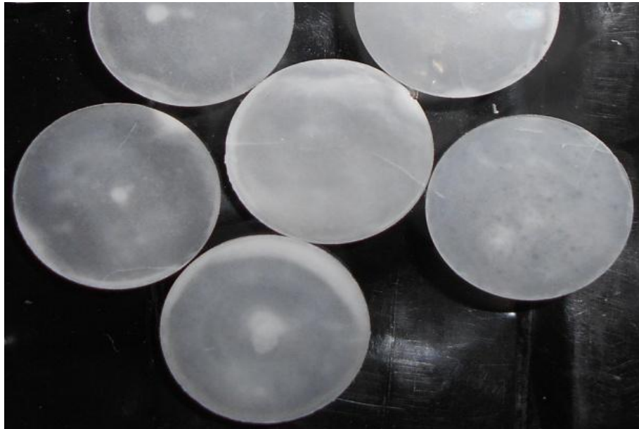
Fig.13 Pastille de KBr utilisées en tant que substrats pour l'analyse FTIR
