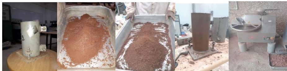
Figure.III.10 Le Présurasse De Fabrication De BTC
