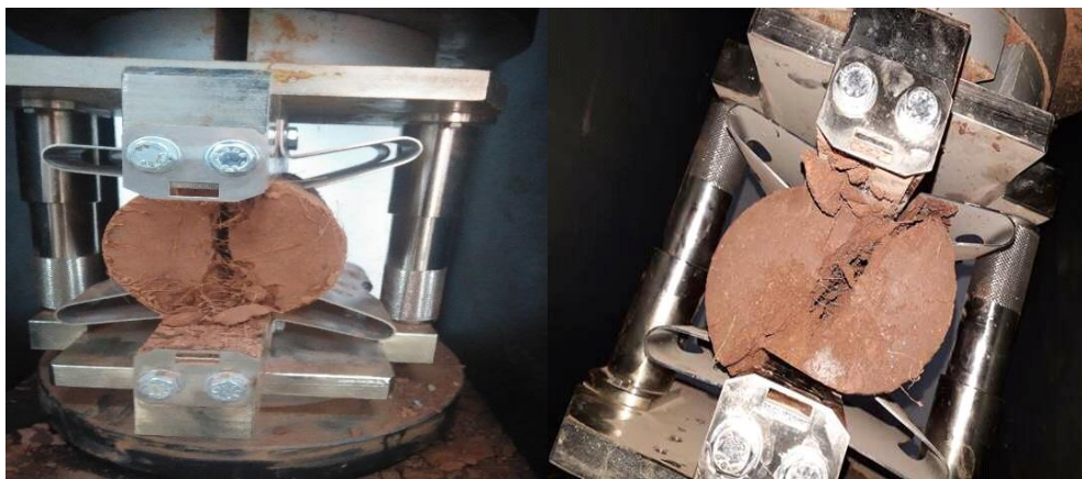
Fig.III.14 : l'essai de traction par fendage.
