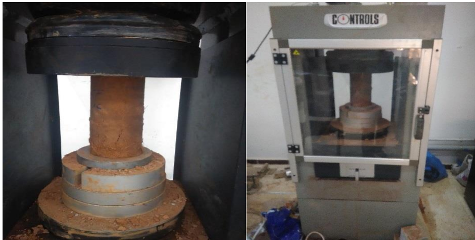
Fig.III.13 : Le bloc après écrasement
