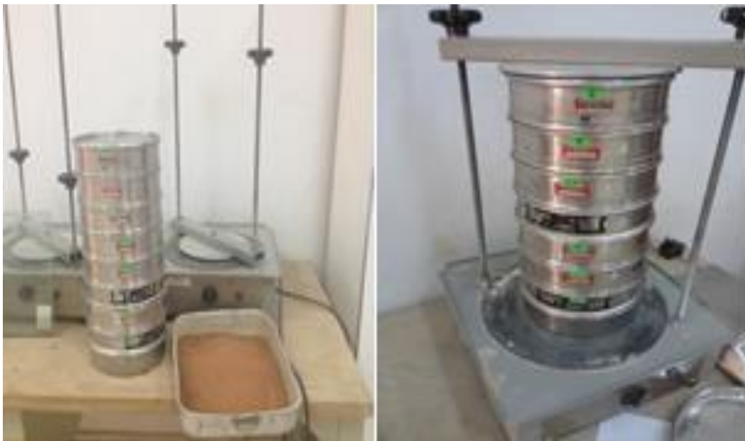
Figure.III.2 Appareillage de l'analyse granulométrique par tamisage
