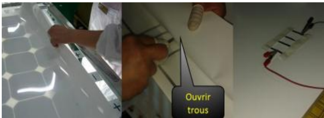
Figure IV.20 : placement du back-sheet test de continuité.
