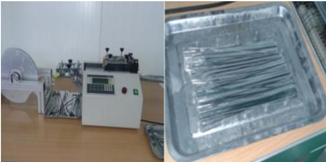
Figure IV.13 : Découpage des rubans de soudure.
