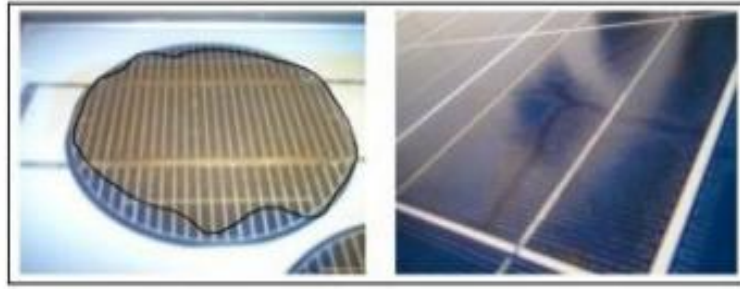
Figure III. 13 : Modules photovoltaïques avec des cellules décolorées.
