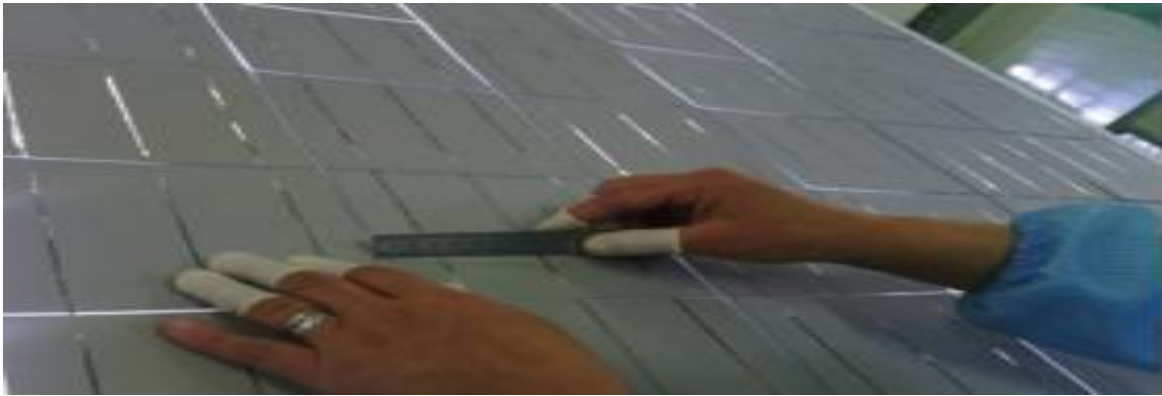
Figure IV.17 : Placement des strings et ajustage des espaces.
