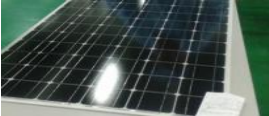
Figure IV.24 : Inspection visuel après lamination.
