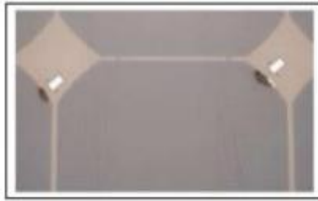
Figure III. 15 : Modules présentant des points chauds sur les bords des coins supérieurs.
