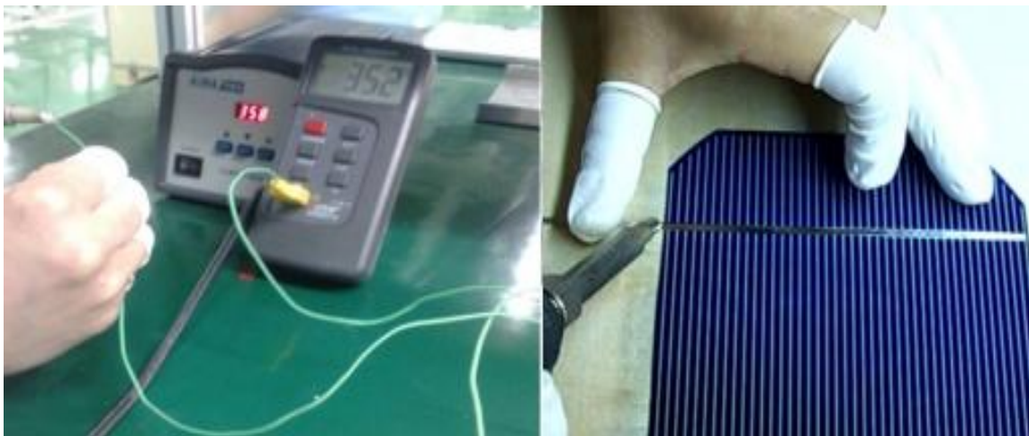
Figure IV.14 : soudage de la cellule.
