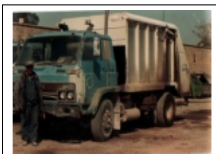
Photo III -2 : véhicule spécialisé ( benne tasseuse)
