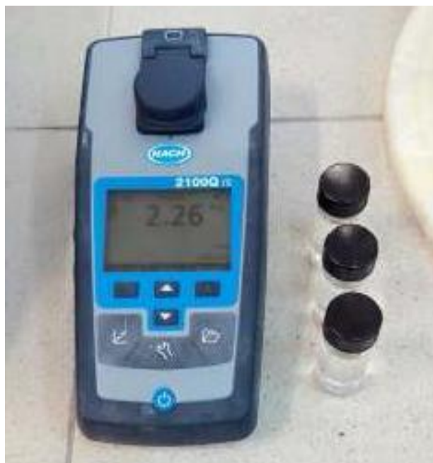
Figure (III-3): Turbidimètre (HACH 21000)
