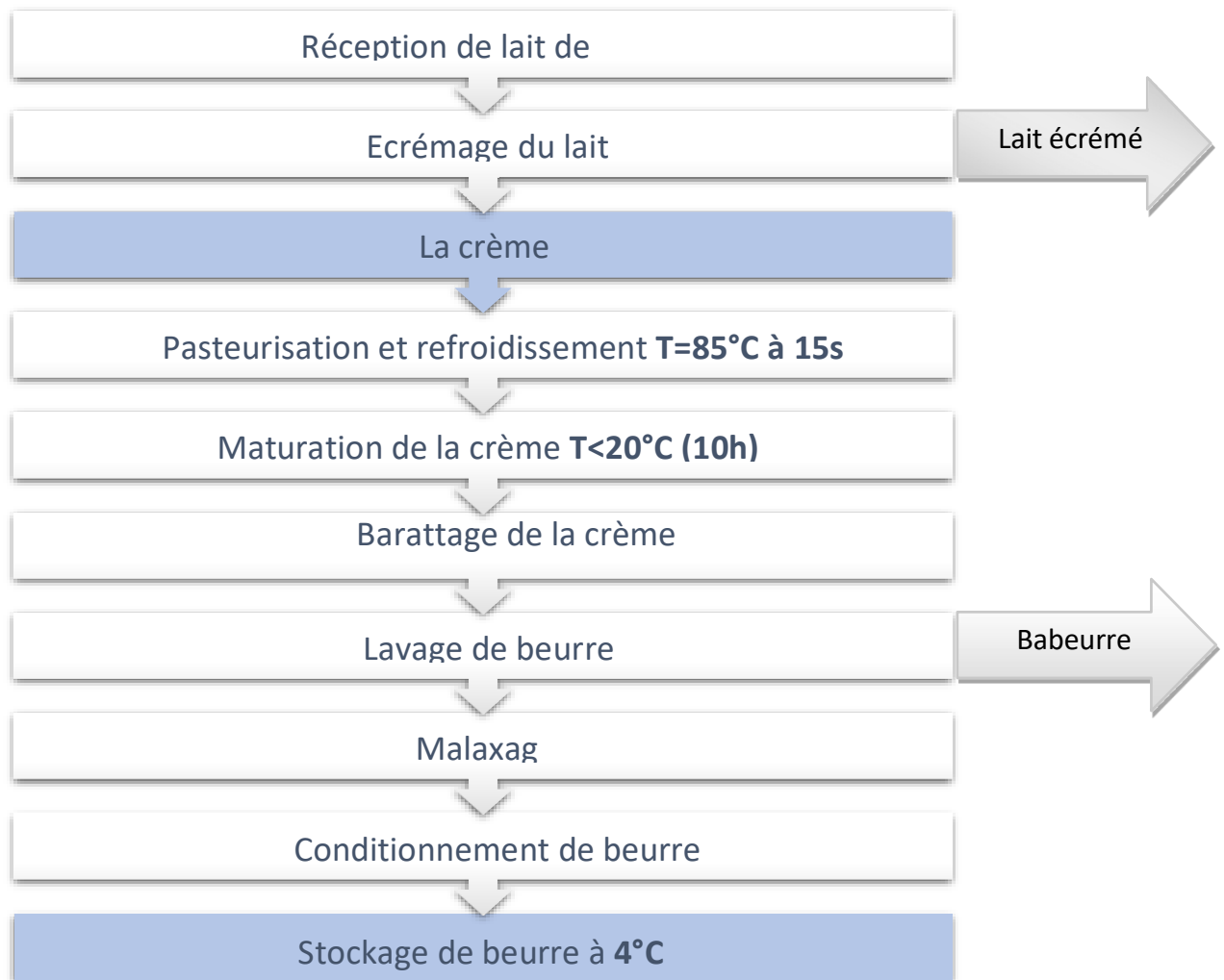
Figure 05 : Diagramme de fabrication du beurre (Angers,2010).
