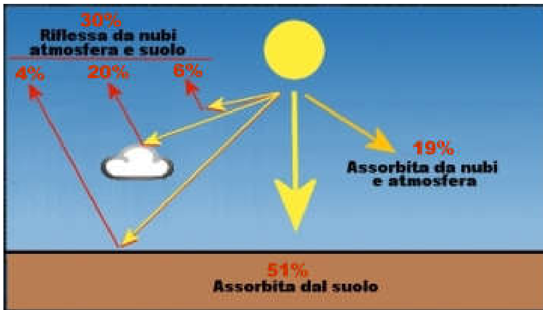
Figure1.3 : Bilan du rayonnement solaire qui arrive sur le sol de la terre [16].
