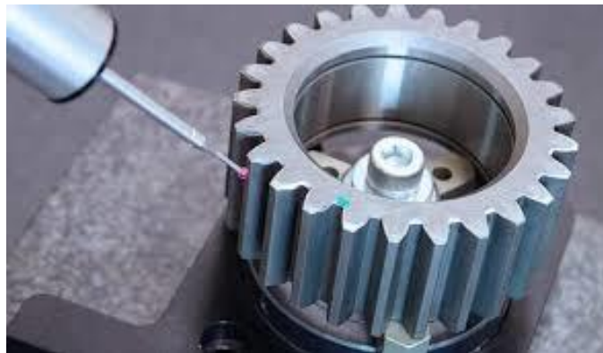
Figure I.12: Contrôler pièce engrenage par MMT [4].
