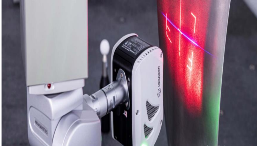
Figure I.13: Contrôler l'aile des turbines par MMT [4].
