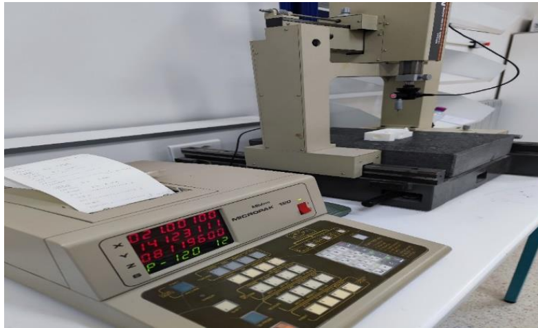
Figure III.17 : Machine mesure tridimensionnelle MMT (labo, métrologie de la faculté de technologie université de M'sila).
