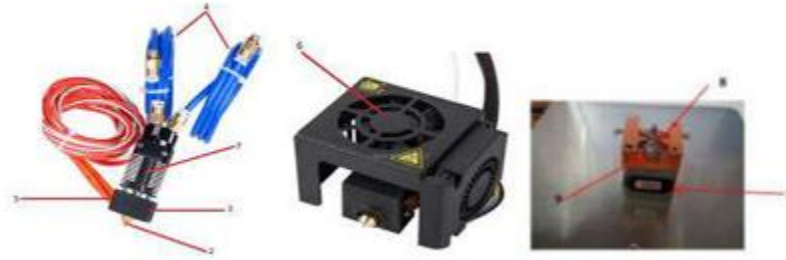
Figure II.11 : Composantes de l'extrudeuse [12].
