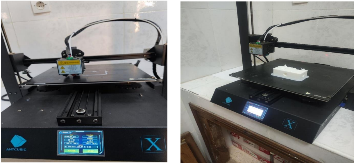
Figure III.9 : Étapes d'impression avec une machine à imprimer.
