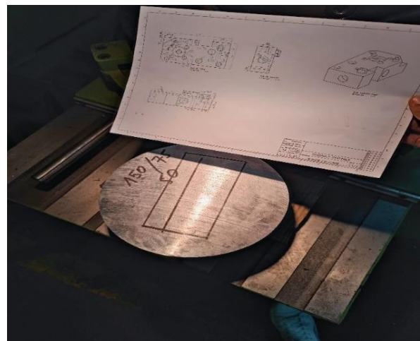
Figure III.11 : Préparation de la pièce brute en aluminium.
