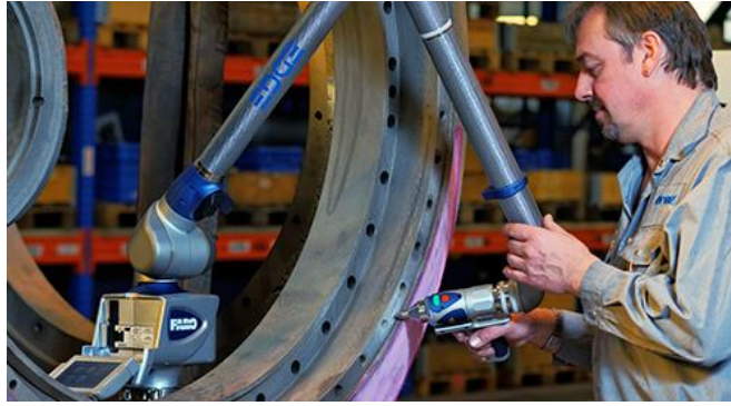
Figure I.9: Contrôle d'une pièce aéronautique par MMT [4].
