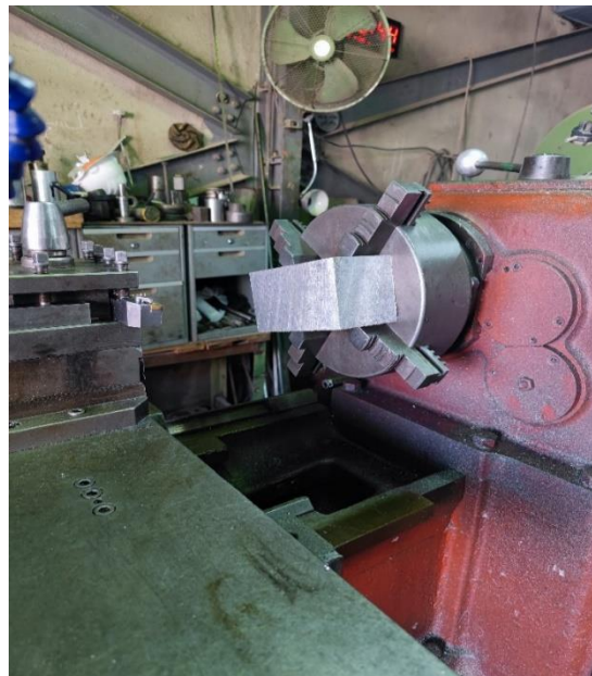
Figure III.13 : début de la fabrication en installant la pièce en aluminium.
