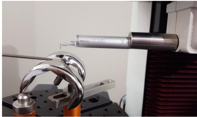
Figure I.11: Genoux contrôlé par MMT [4].
