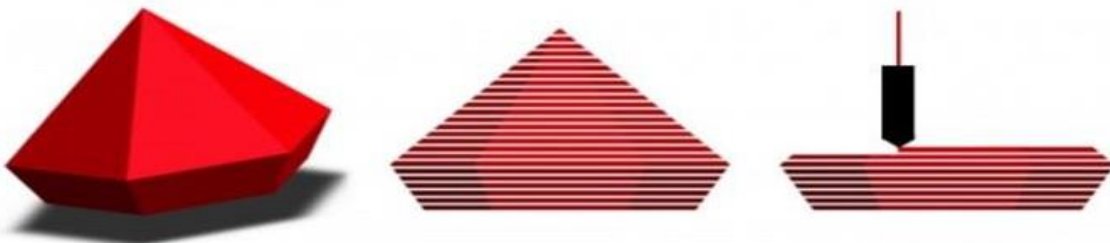
Figure II.2 : Impression couche par couche [8].
