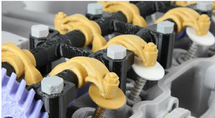
Figure II.23: Une pièce motrice imprimée complètement en 3D [14].
