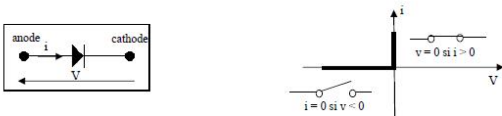
figure I.20. Diode idéale (néglige la tension de seuil et la résistance interne).
