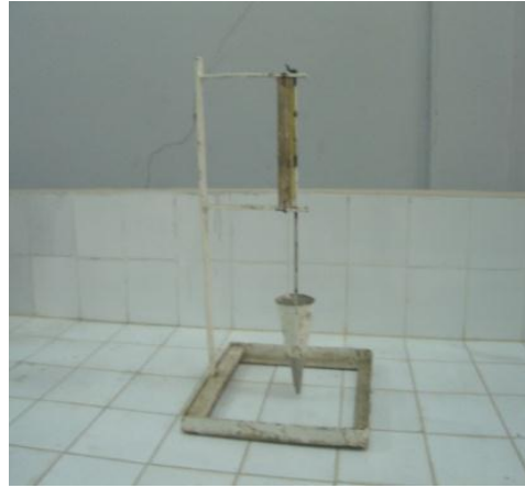
Figure II.1 : Mesure de la fluidité du mortier.
