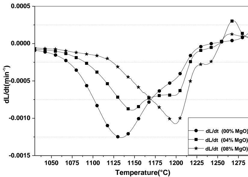
الشكل (7.III): منحنى التمدد الطولي التفاضلي للمسحوق مع إضافة تراكيز مختلفة من MgO
