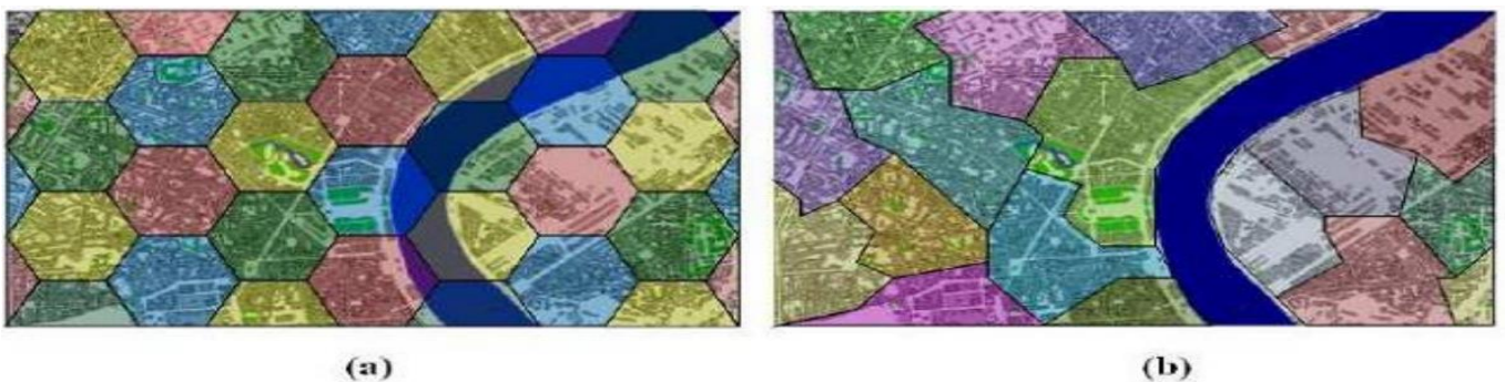
Figure I.3 : Concepts cellulaires : (a) pavage régulier, (b) couverture réel [6].
