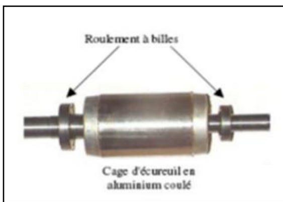
Figure I. 7: Photo du rotor d'une machine asynchrone.
