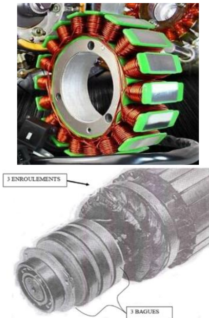
Figure I. 11 : Machine asynchrone à rotor bobiné.
