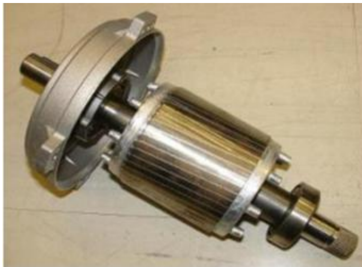
Figure I. 8: Machine asynchrone à moteur à cage.
