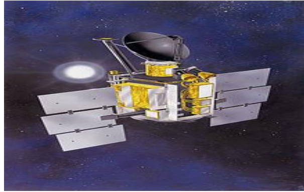
Figure I.8 : Satellite QuikSCAT qui mesure les vents grâce à un diffusomètre
