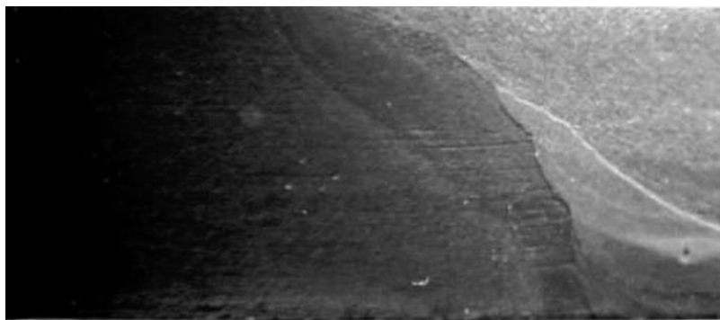
Figure IV.31 macrographie de la soudure avec une 1ère réparation (R1)
