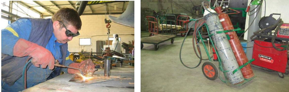
Figure 1.1. Soudage au chalumeau
