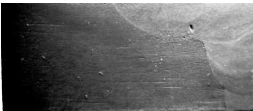
Figure IV.31 macrographie de la soudure avec une 1ère réparation (R1)
