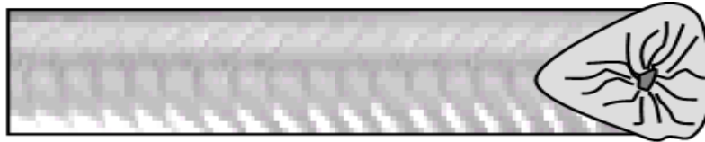
Fig. II.6- Forme du cordon lors d'un soudage lent
