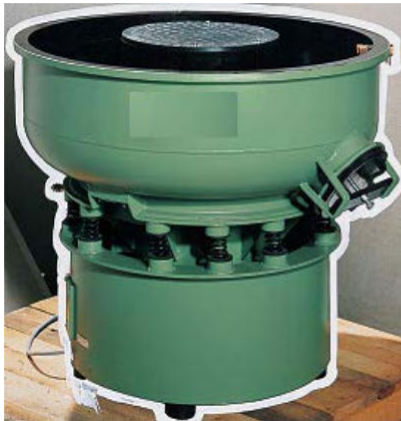
Fig.I.7 Machine vibratoire d'une chambre en forme circulaire [17]
