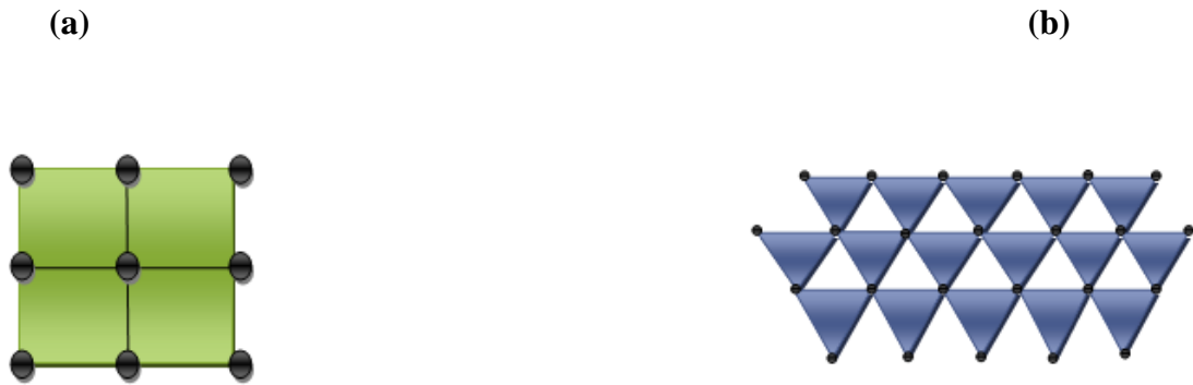
Figure I.5 : Différentes familles de cristaux photoniques bidimensionnels : (a) réseau carré (b) réseau triangulaire
