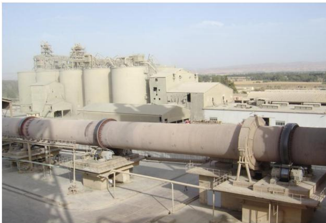
Fig. I.4 Four rotatif long: ligne sèche
